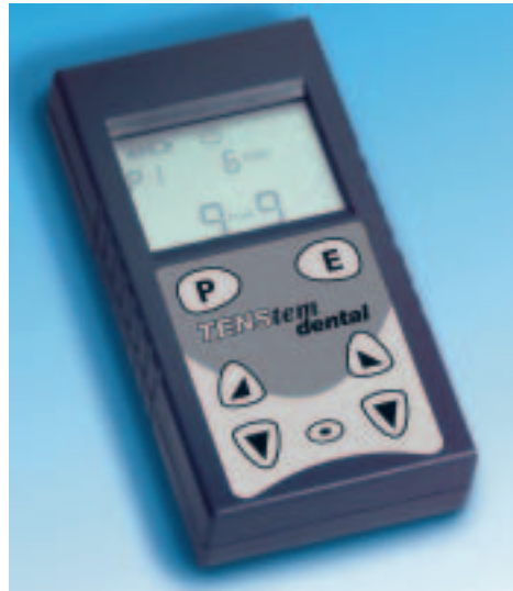
Abb. 8: Das TENStem dental der Firma Schwa-Medico verfügt über die korrekten Parameter zur Muskelentspannung und auch über die Möglichkeit zur Einstellung der Balance zwischen den stimulierten Kopfhälften.
