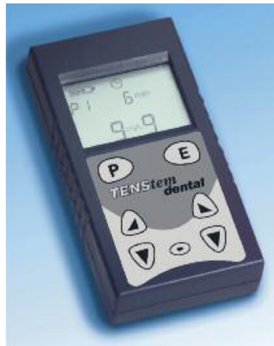
Abb. 2: Moderne TENS-Geräte für die Myozentrik verfügen über eine Balance- und Pausefunktion bis hin zu einer Protokollfunktion zur Kontrolle der erfolgten vorbereitenden Heimanwendungen durch den Patienten.
